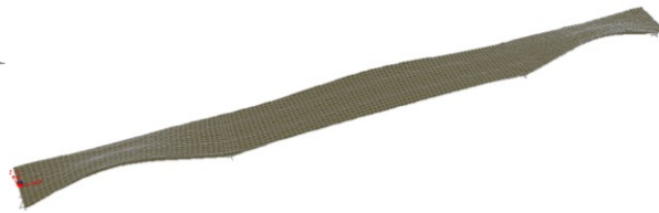
2º Modo Misto (Lateral + Torção) – 14.04 Hz
