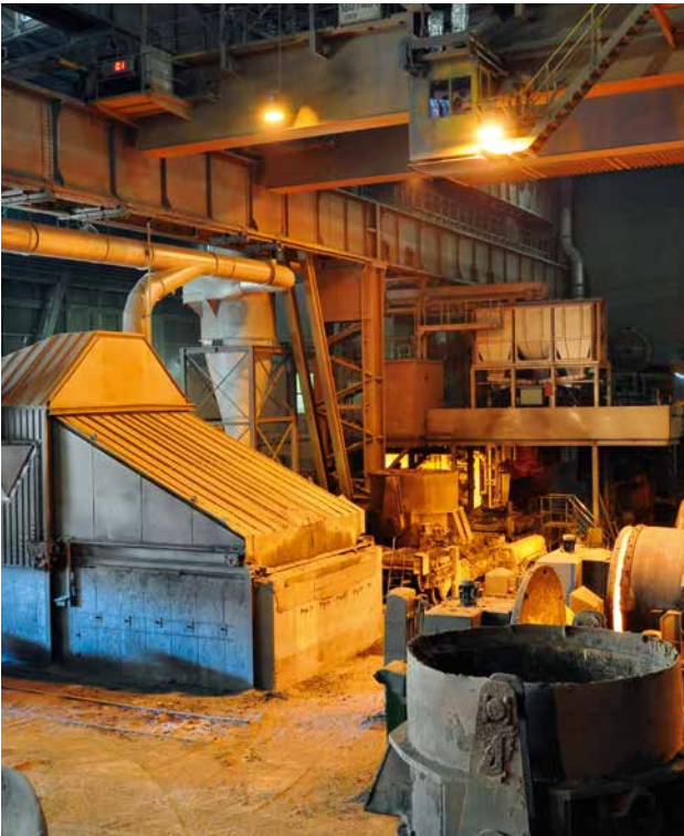
Installierte Absaughaube über der Pfannenschlackebox (links) sowie Schlackenmanagement E-Ofenschlacke in der Stahlwerkshalle (rechts)
