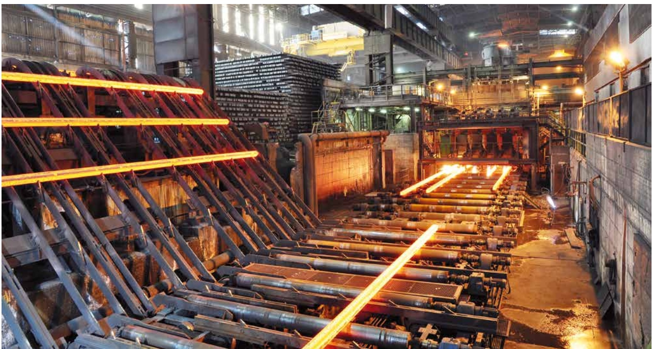
Stranggussanlage in Betrieb, Erzeugung von Knüppeln
