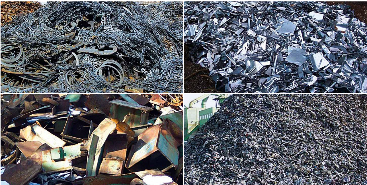
Chargierfähige Schrotte zum Einsatz im E-Ofen der ESF, hier: Alt- und Neuschrotte, Schredderschrott (von links oben nach rechts unten)
