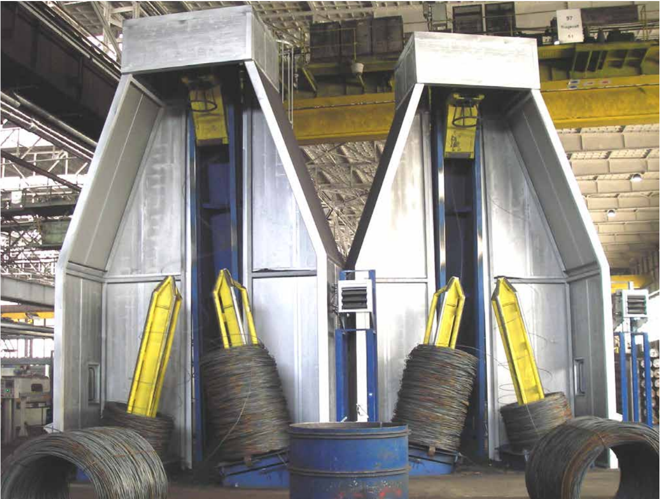
Walzdrahtablauf der TEUREMA-Reckanlagen mit realisierten Schallschutzmaßnahmen
