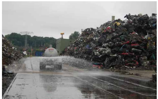
Regelmäßige mobile Befeuchtung der Straßen (hier: Bereich Kondirator)
