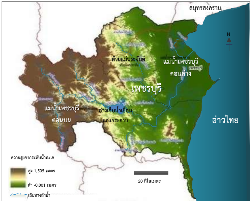
ภาพที่ 1.5 โครงสร้างทางภูมิศาสตร์ฐานวิทยาและเครือข่าย (Network) ของ “ลุ่มน้ำเพชรบุรี” จังหวัดเพชรบุรี จากเขตต้นน้ำทางทิศตะวันตกเฉียงใต้ ไหลลงสู่อ่าวไทยทางด้าน ตะวันออกของพื้นที่ (ที่มา: ปรับปรุงจาก กรมแผนที่ทหาร, 2554)
