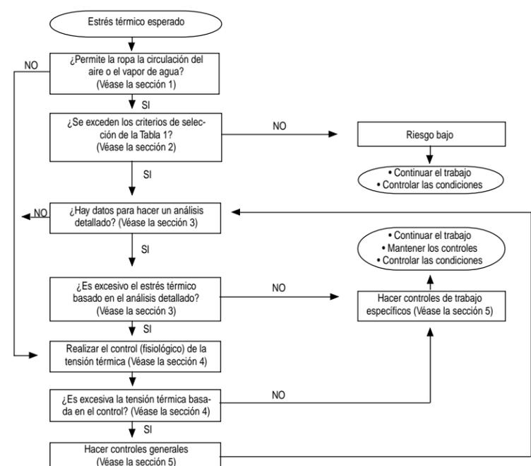
Figura 1. Esquema de evaluación para el estrés térmico.
