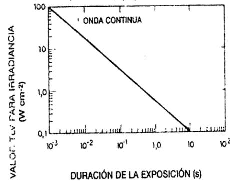
Figura 3 b. Valor TLV para exposición de la piel y los ojos a láser de onda continua para radiación infrarroja lejana. (Longitudes de onda superiores a 1,4 μm).
