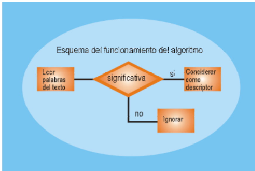
Fig. 2. Esquema del funcionamiento del algoritmo [15, p. 131] 9
