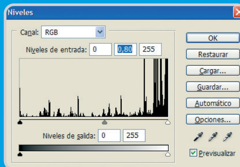
La excesiva pigmentación azul de algunas fotografías tomadas con cámaras digitales en entornos con mucha luz solar puede paliarse ajustando con precisión los niveles de los canales Azul y Verde .
