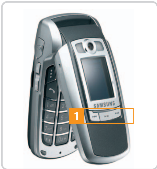
Los controles externos [1] facilitan la interacción del usuario con el reproductor, por lo que un terminal que pretenda ser competente debería tenerlos; es el caso del Samsung E720 analizado en un número anterior de la revista e incluido en la presente comparativa.
