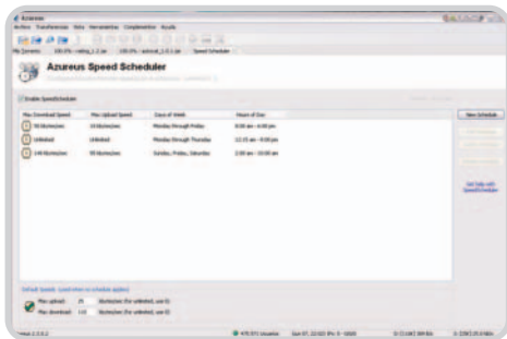
El complemento Speed Scheduler nos permitirá programar los días y horas que queramos con más o menos ancho de banda.
