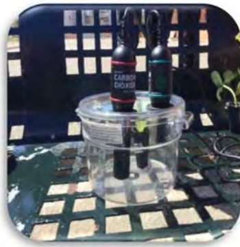
Figura 2. Los sensores digitales de dióxido de carbono y de oxígeno (imagen de la izquierda) así como el sensor digital para el estudio experimental del movimiento (imagen de la derecha) son algunos ejemplos de algunos de los sensores digitales que usamos en nuestro laboratorio escolar del IES Isla Verde (Algeiras, Cádiz) durante la fase de experimentación de la propuesta interdisciplinar de “Estudio de la capacidad fotosintética de diferentes especies vegetales del huerto escolar” y “Galileo en el IES Isla Verde: cálculo de la aceleración de la gravedad a través del estudio experimental del movimiento en un plano inclinado”.
