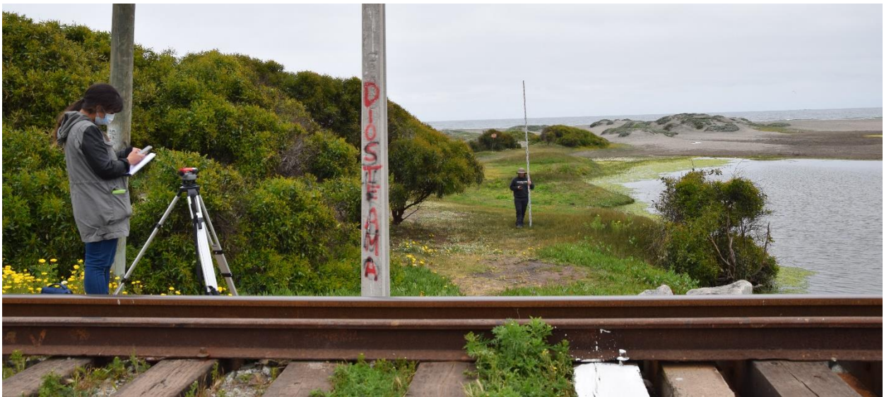
Figura 99. Terreno del día 2020-10-23. Levantamiento topográfico y vuelo drone para construir modelo de elevación vertical.
