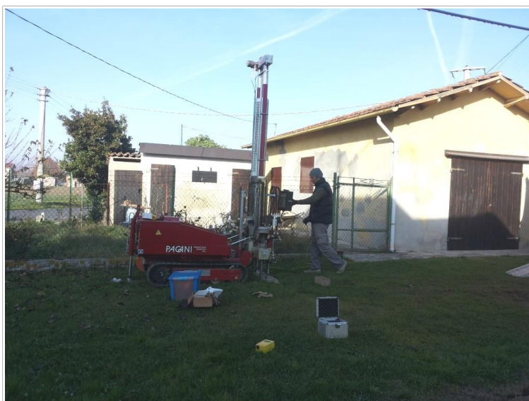
Foto 4.2 - Prova CPTU eseguita in località Piombino con associata una registrazione sismica HVSr
