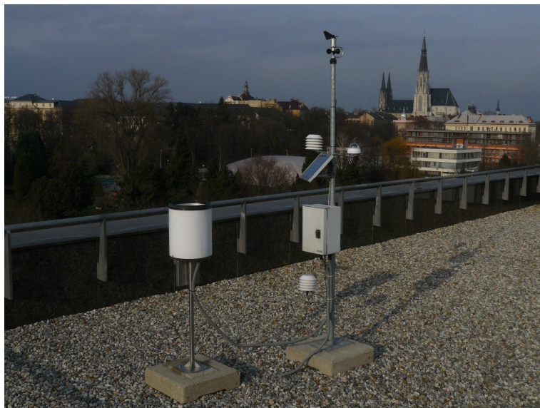
Obr. 77: Automatická meteorologická stanice MESSO Olomouc Envelopa
