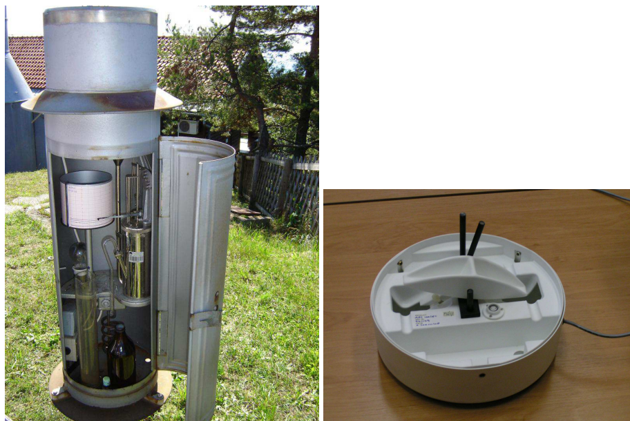
Obr. 75: Omrograf ( http://fredek.net/ZEVS_arhiv/viewtopic.php?t=1165&sid=f04cd913ab1b4d59250f2142df03745e ) a detail automatického člunkového srážkoměru
