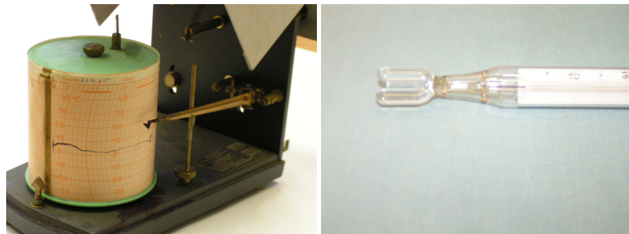
Obr. 69: Detail termografu a minimálního teploměru
