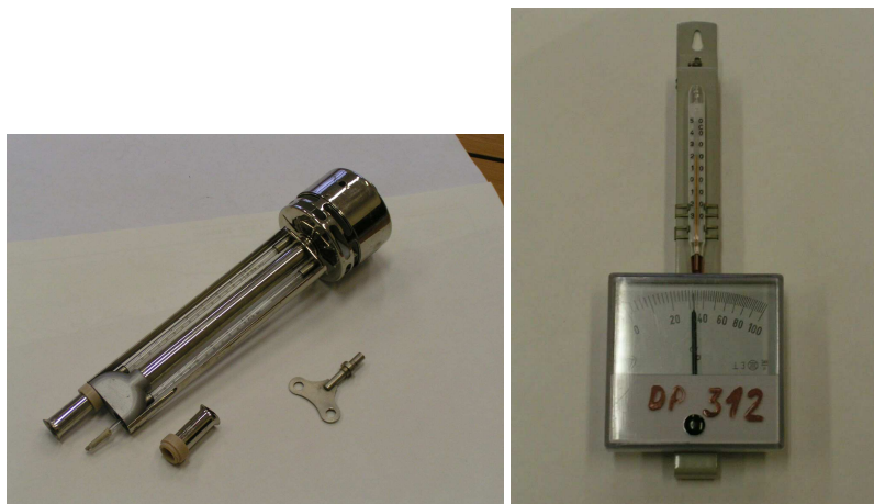
Obr. 71: Assmannův aspirační hygrometr a vlasový hygrometr
