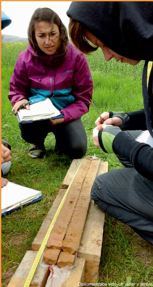
Dokumentace vrtných jader v terénu
