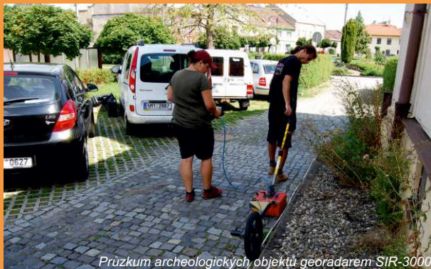
Průzkum archeologických objektů georadarem SIR-3000
