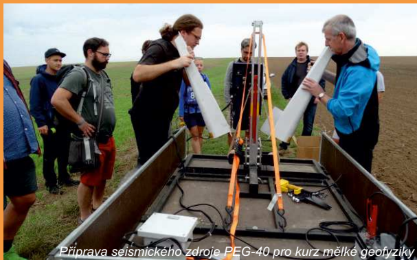
Příprava seismického zdroje PEG-40 pro kurz mělké geofyziky
