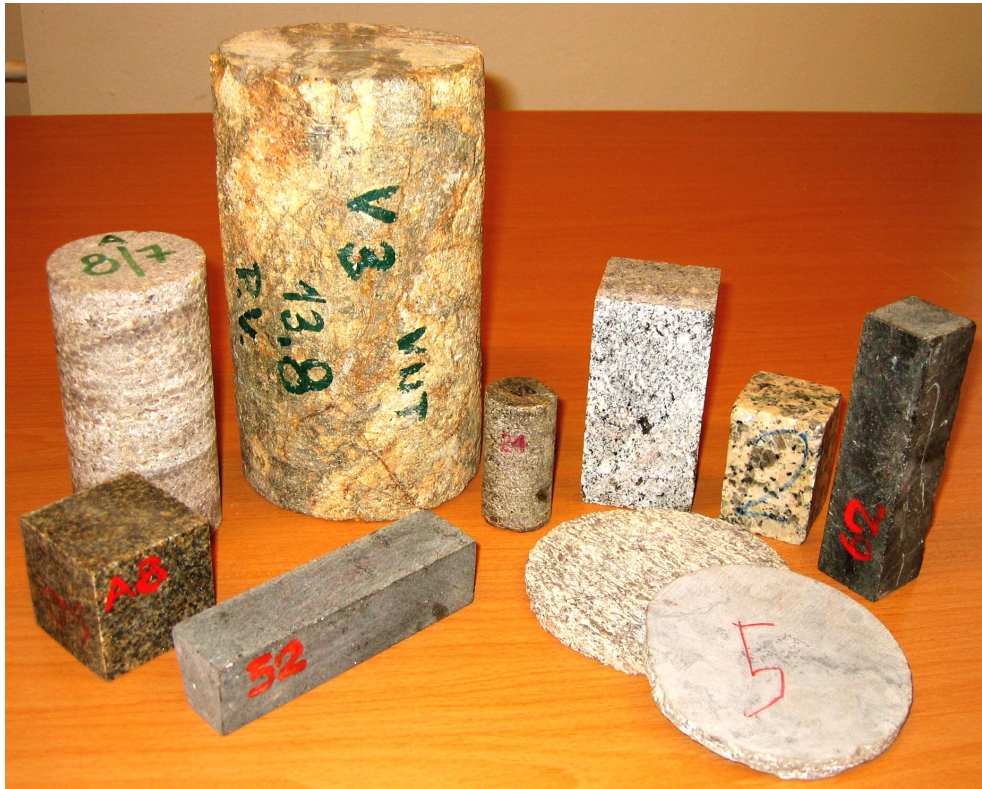
Obr. 10.4 Typy zcela opracovaných (pravidelných) zkušebních tělísek
