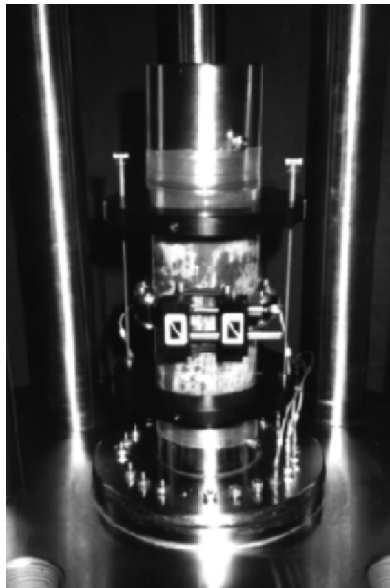
Obr. 10.22 Vysokotlaká triaxiální komora [až 70 MPa plášťového tlaku a 1 000 kN axiálního zatížení] (GCTS, Canada)
