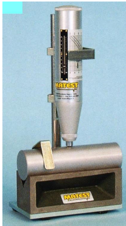
Obr. Obr. 10.24 a 10.25 Měření skleroskopické tvrdosti horniny Schmidtovým kladívkem typu L. Vzorek je pevně upnutý na masivní podložce a kladívko je vedené přípravkem (Hučka, 1964, fy MATEST s.r.l., Bergamo, Italy)
