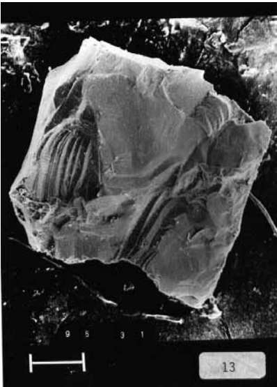
Figura 44. Microtexturas. Granos de cuarzo de ambiente periglacial andino (escala 100 \mu ), izquierda de depósitos criometeorizados, derecha de glaciar de escombros / Microtexture: Quartz grains from Andean periglacial environment (scale: 100 \mu ); left: frost weathering; right: from rock glacier (Fuente: Trombotto)
