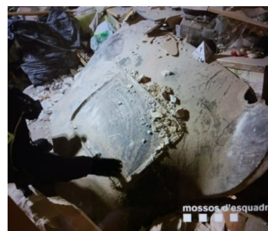
Figura 4-9. Fragment de metralla del reactor R3131 que va anar a parar a Torreforta
