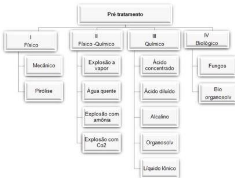
Figura 6 - Diagrama com diferentes métodos de pré- tratamento de materiais lignocelulósicos. Fonte: Ferreira, 2016.
