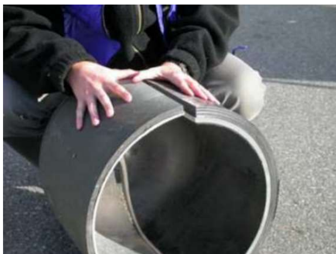
Rys.10 Ścianki zbiorników dostosowane do różnych ciśnień
