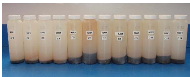
Série de 12 godets décrivant une collecte séquentielle des matières en suspension © AEL
