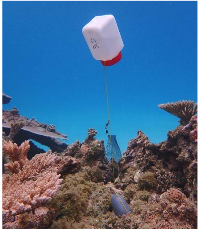
Dispositif de monitoring passif de type « Window-Screen » (WS) déployé in situ © Institut Louis Malardé
