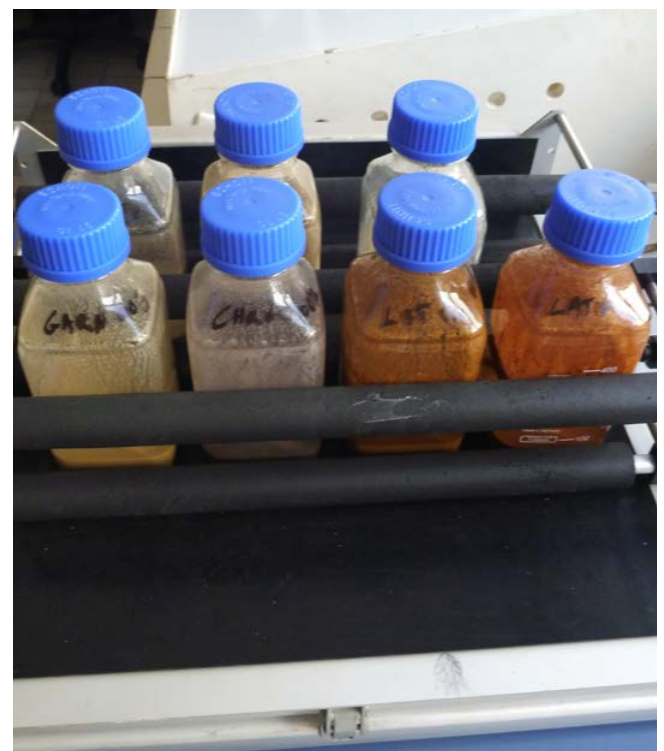
Élutriations standardisées de sédiments pour extraction de la fraction relarguable biodisponible des contaminants © Senia J., Aquabiotech
