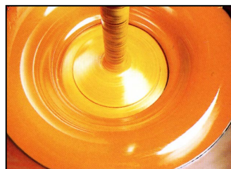
Abbildung 7-8: Vordispersierung im Dissolver aus Weyres, [5], S. 32
