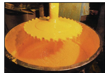
Abbildung 7-8: Vordispersierung im Dissolver aus Weyres, [5], S. 32
