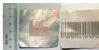
Obr. 1-9 RFID čip s anténou
