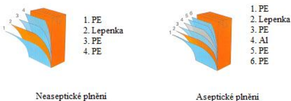
Obr. 2-80 Složení obalu TetraPak
