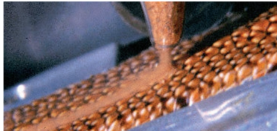
Bei welchem Neigungswinkel der Haut des Sandskinks fängt der Sand an zu rutschen? Forscher ermitteln so den Reibungswiderstand der Haut, die ihn durch den Sand „schwimmen“ lässt. Die Haut des Sandskinks besitzt sogar weniger Reibung als Glas und Stahl.
