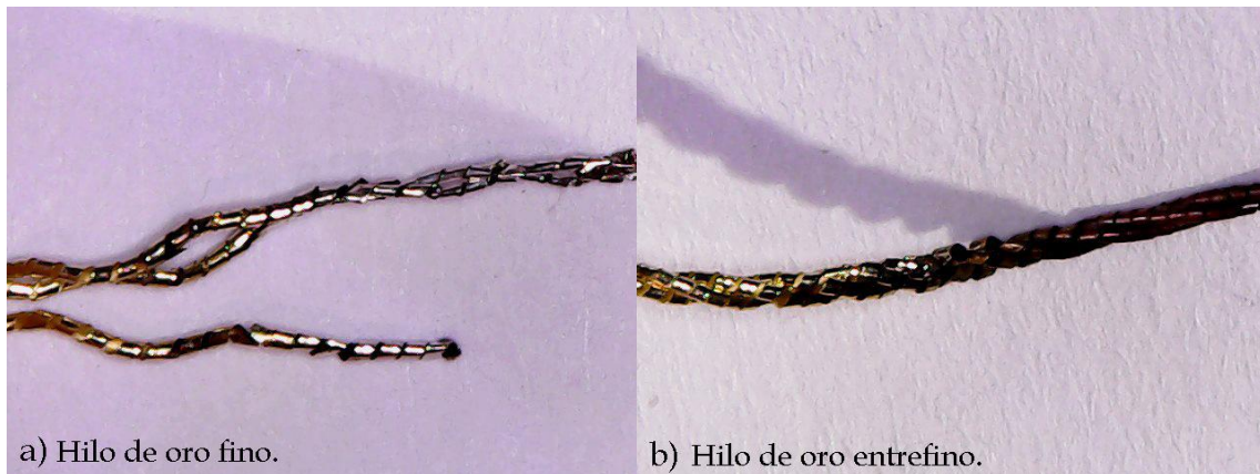
Figura 6: Hilos de oro de distintas calidades tras ensayo por vía seca. 8
