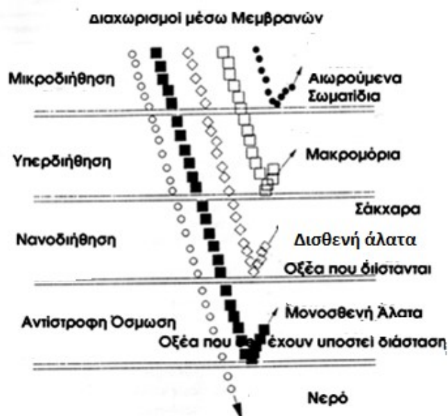
Σχήμα 1.5: Διαχωρισμός σωματιδίων με τις διάφορες μεθόδους διαχωρισμού με μεμβράνες
