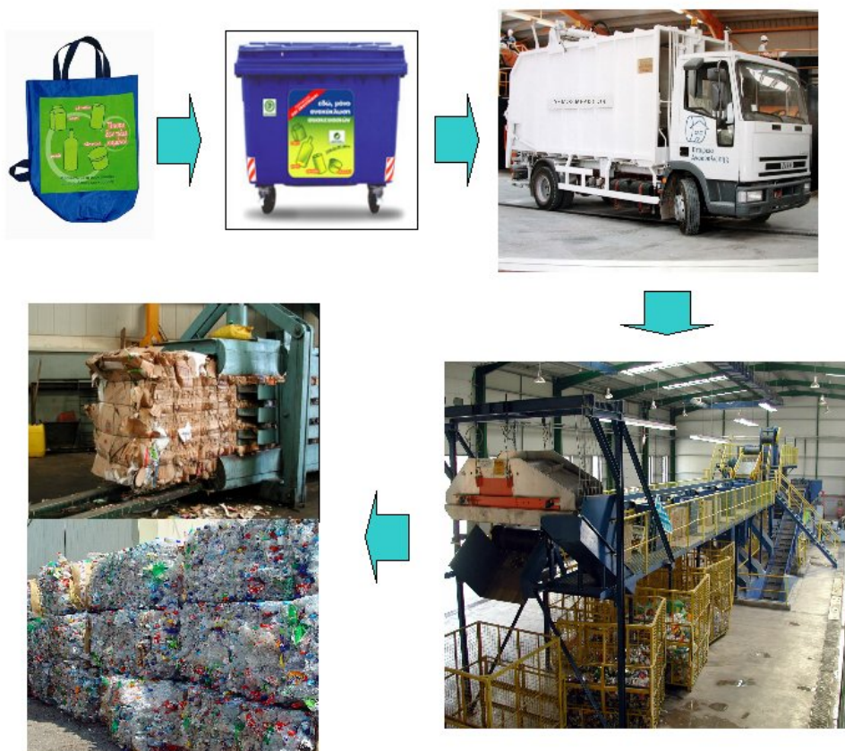
Σχήμα 5.4: Ρεύμα ανακύκλωσης – Μπλε κάδοι Ε.Ε.Α.Α.
