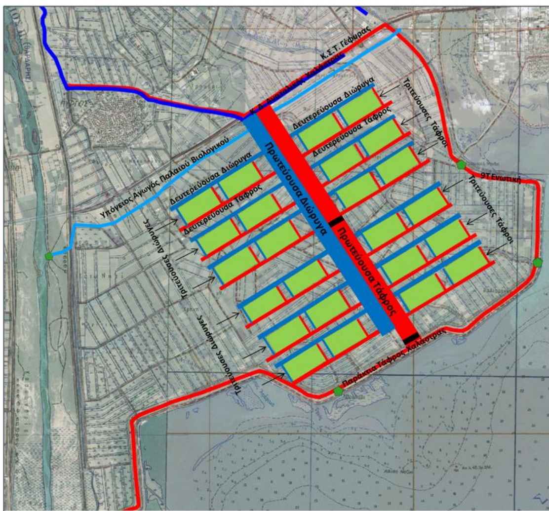
Εικ.9.4.3: Σχηματική αναπαράσταση της επαναχρησιμοποίησης του νερού με τη μέθοδο των αναβαθμίδων. Οι αναβαθμίδες που δημιουργούνται από το κλείσιμο των θυροφραγμάτων αναπαριστώνται με μαύρη γραμμή στην πρωτεύουσα τάφρο.
