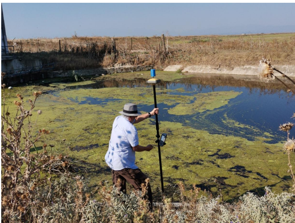
Εικ.8.2.2: Λήψη στιγμάτων με το σύστημα GNSS(TOPCON).
