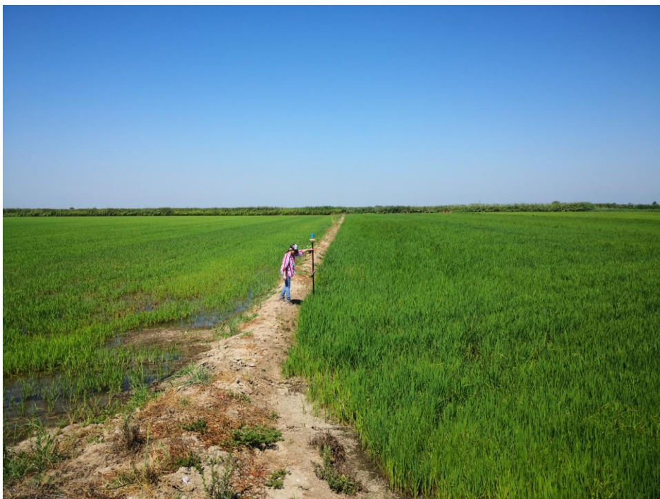
Εικ.8.2.1: Λήψη στιγμάτων με το σύστημα GNSS(TOPCON).
