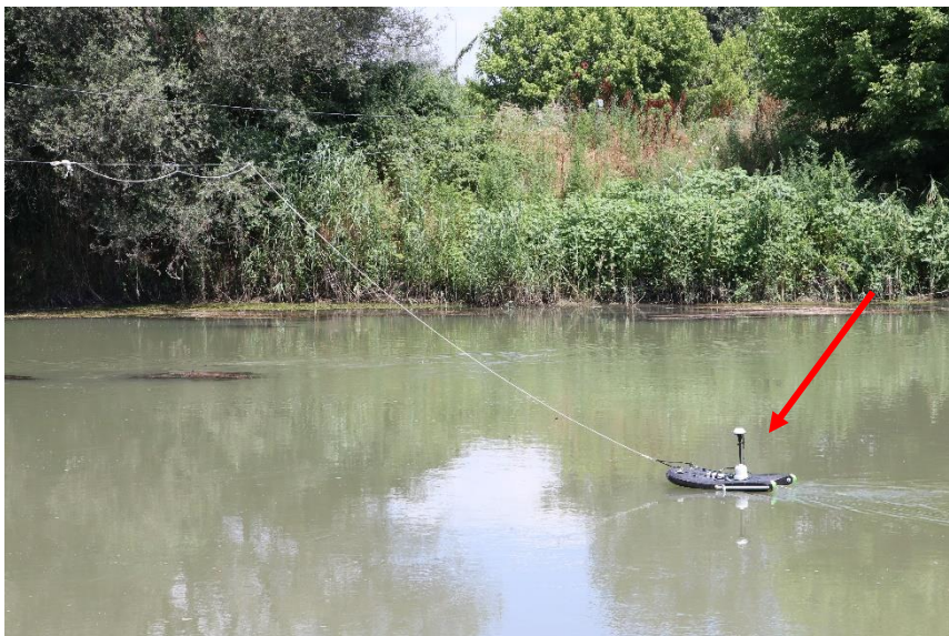
Σχήμα 3.5: Καταγραφή κοίτης με ηχοβολιστικό
