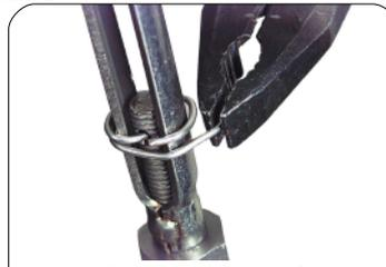
Spannschloss mit Sicherungsdraht fixieren.
