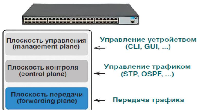
Рисунок 2 – Архитектура сетевого устройства
