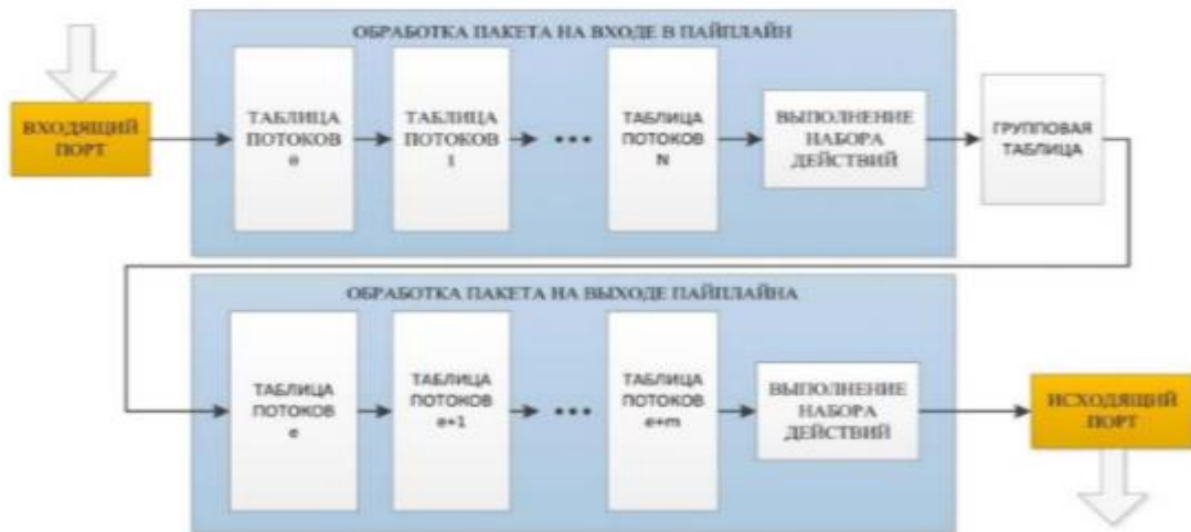
Рисунок 12 – Конвейерная обработка пакета
