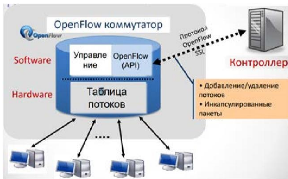
Рисунок 7 – Связь коммутатора и контроллера по OpenFlow
