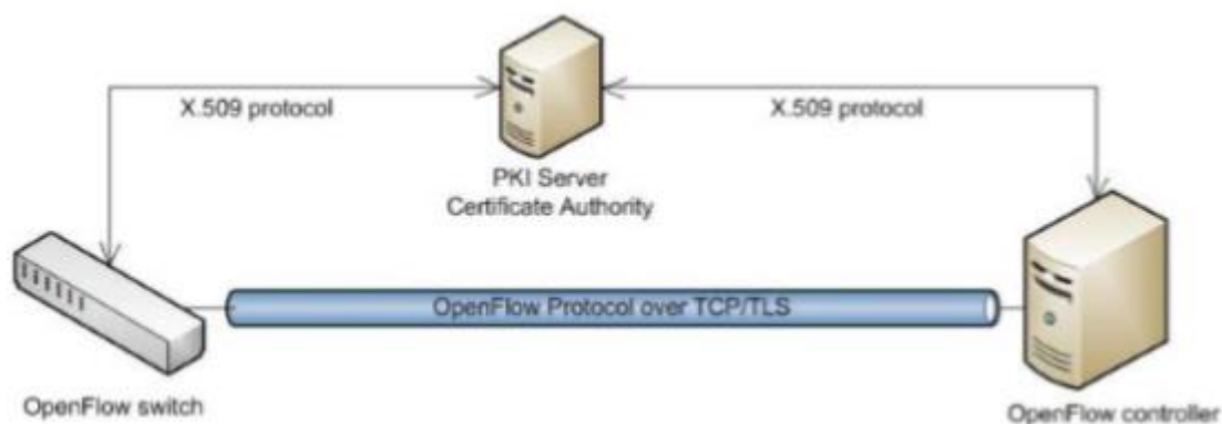
Рисунок 17 – Безопасный канал на основе протокола TLS
