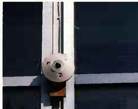
Abb. 78 Solarimeter an der Testfassade
