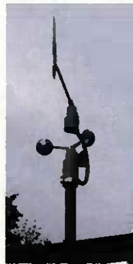
Abb. 29 Schalenkreuz-Anemometer und Windfahne vor den Testelementen
