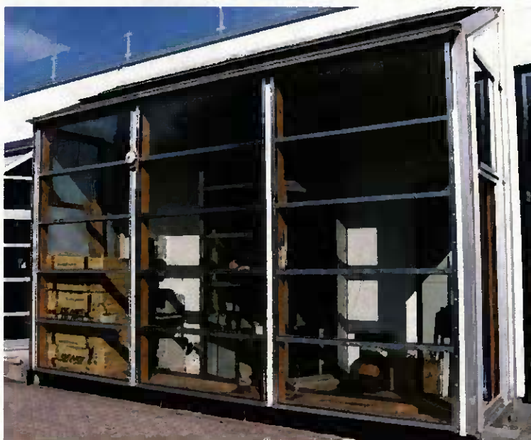
Abb. 73 Außenansicht der Testfassade an der Prüfhalle des ift Rosenheim
