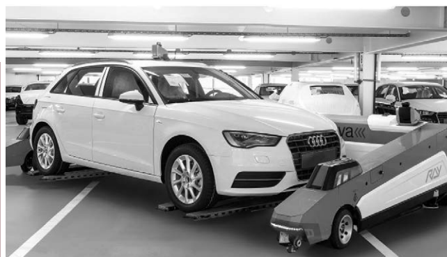
Rys. 9. Bezzałogowy zrobotyzowany system transportowy w fabryce Audi [23]
