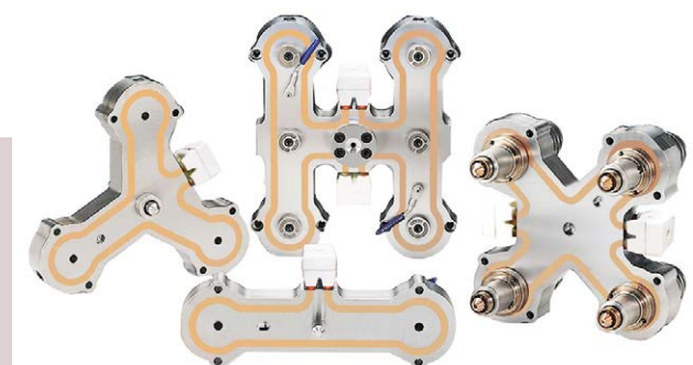
Rys. 2. Przykładowe kształty rozdzielaczy gorących kanałów (źródło: http://yudopl.com )
