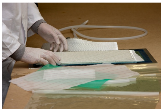
Figura 2 Col·locació de les capes de reforç (teixit de fibra de vidre)
