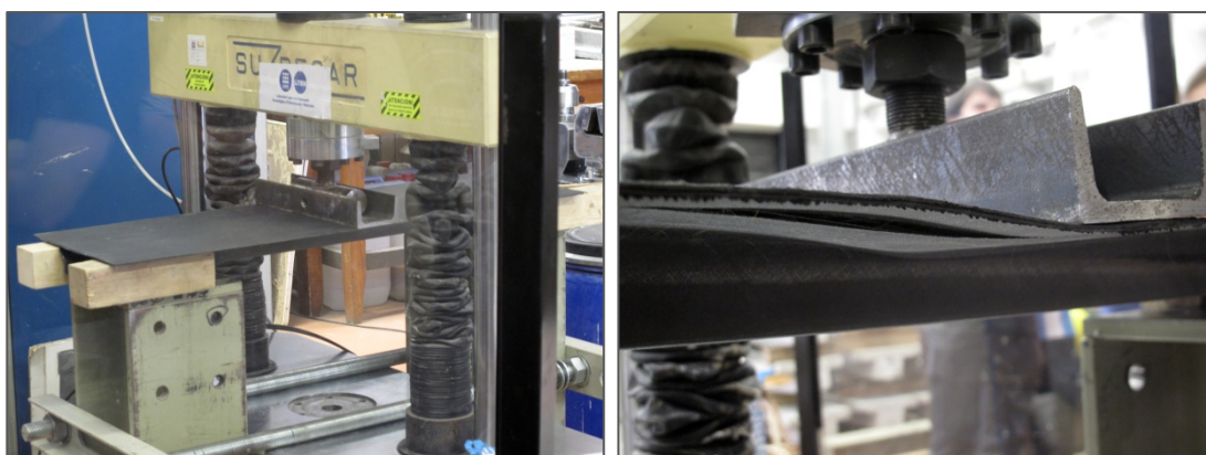
Figura 15 Mecanismes de fallida de l' stringer
