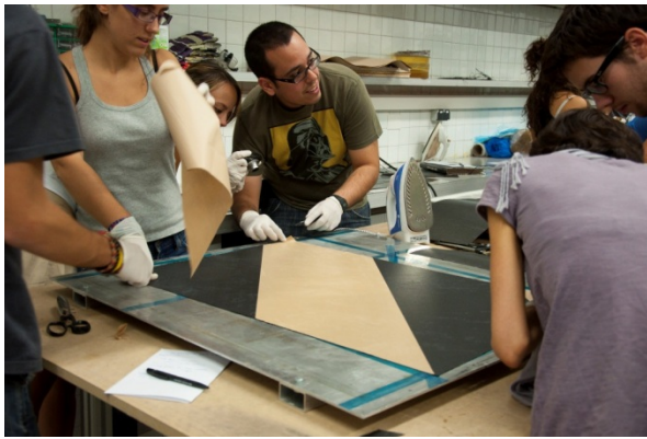
Apilat de capes de preimpregnats de fibres de carboni amb resina epoxi.
