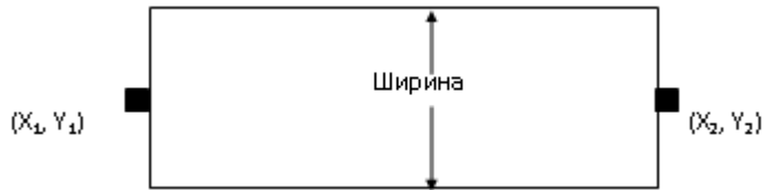
Задание координат и ширины площадного источника
