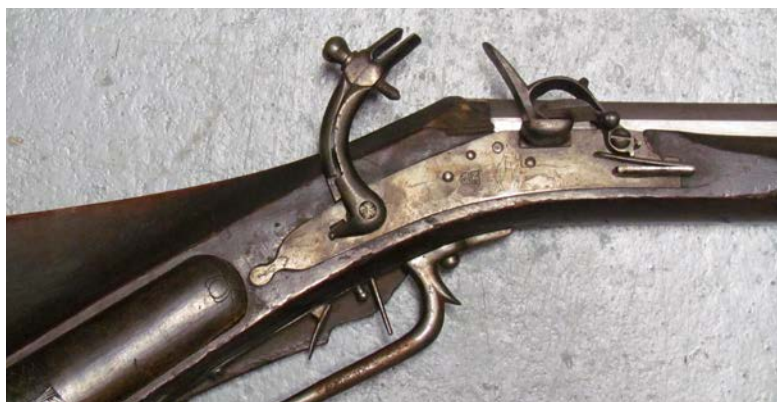
Obr. 6 Křesadlový zámek skandinávského typu, značený NRS – Švédsko, 17./18. stol. – zámek Kynžvart
