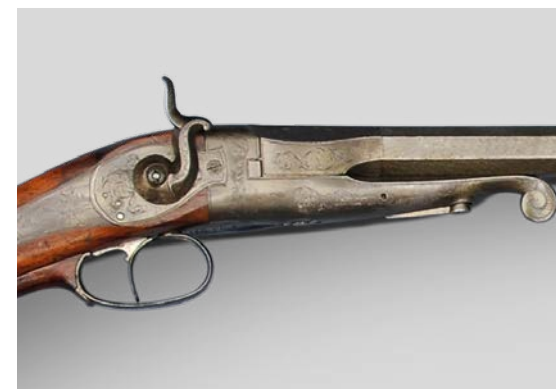
Obr. 69 Otočný blokový závěr Béringer, A. V. Lebeda Praha okolo r. 1850 – zámek Lysice
