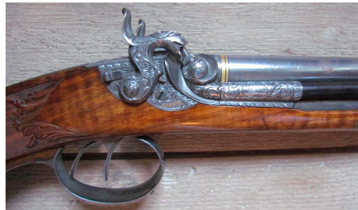
Obr. 62 Perkurní skříňkový zámek – dvojka s bočními kohouty, A. V. Lebeda Praha r. 1836 – zámek Frýdlant
