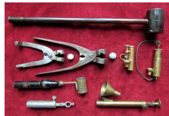
Obr. 80 Nabíjecí kladívko, kleště na litý střel, měřky na prach a rychliče, Rakousko, okolo r. 1850 – soukromá sbírka
