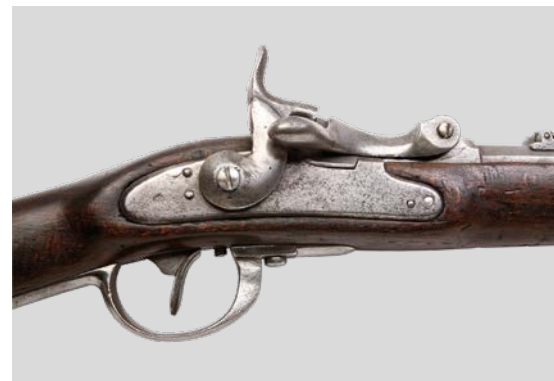
Obr. 66 Odklopný závěr Wänzel, Rakousko vz. 1854/67 – muzeum Vyškovska
