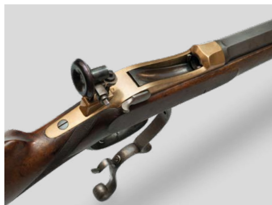
Obr. 65 Sklopný závěr Bornmüller, Suhl, Německo okolo r. 1885 – zámek Lysice
