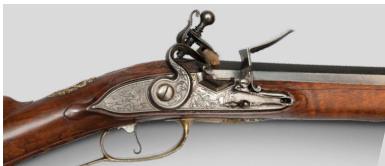
Obr. 8 Křesadlový zámek francouzského typu, Čechy, pol. 18. stol. – zámek Lysice
