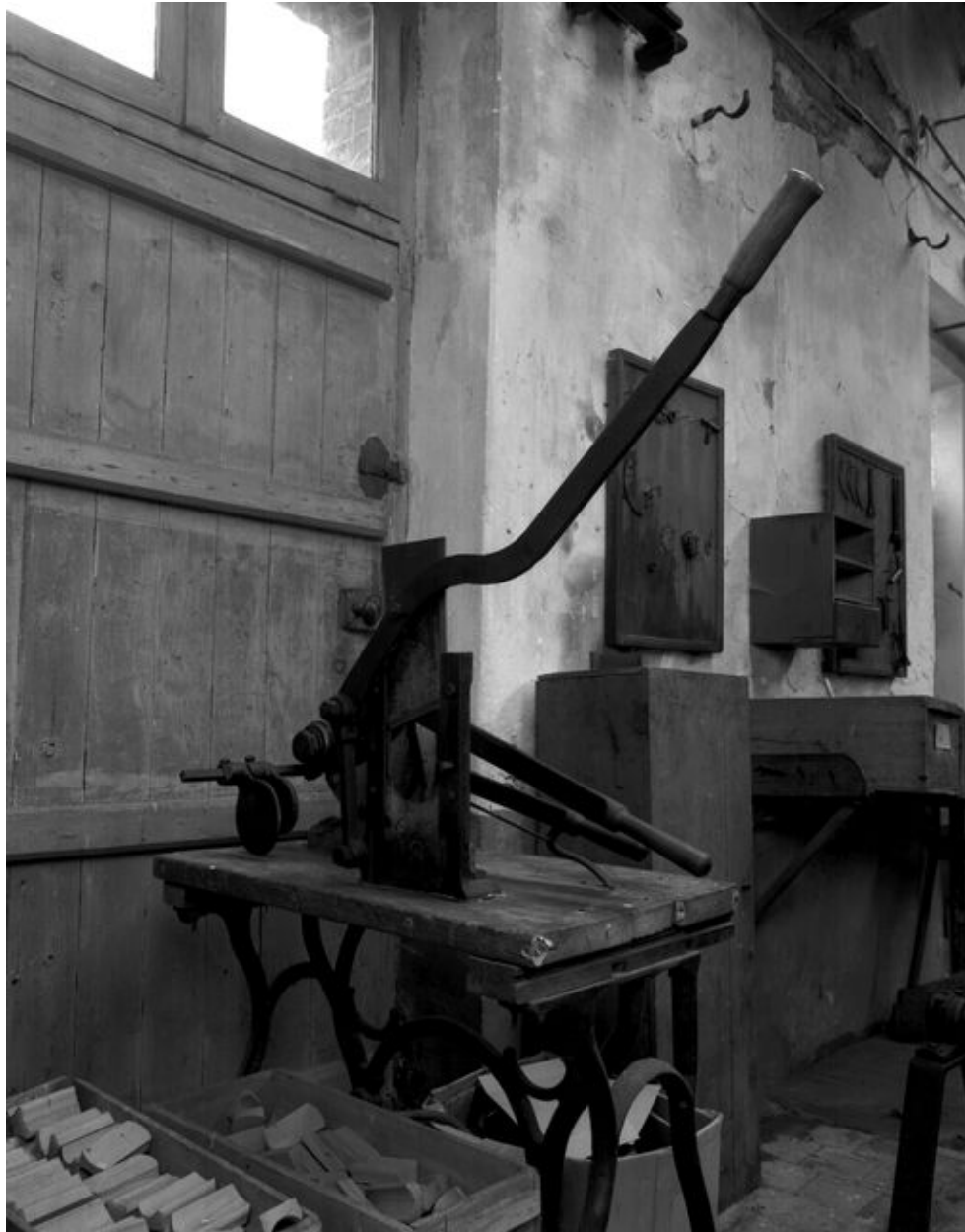
Vue d'ensemble de la machine servant à couper les poils des écheveaux.
