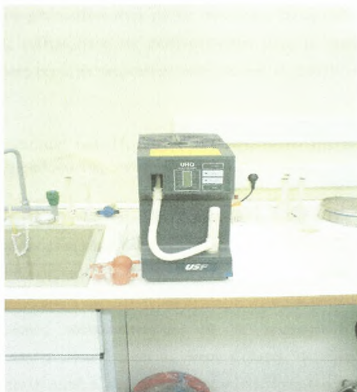
Εικόνα 2.4. Συσκευή παραγωγής ύδατος υψηλής καθαρότητας
