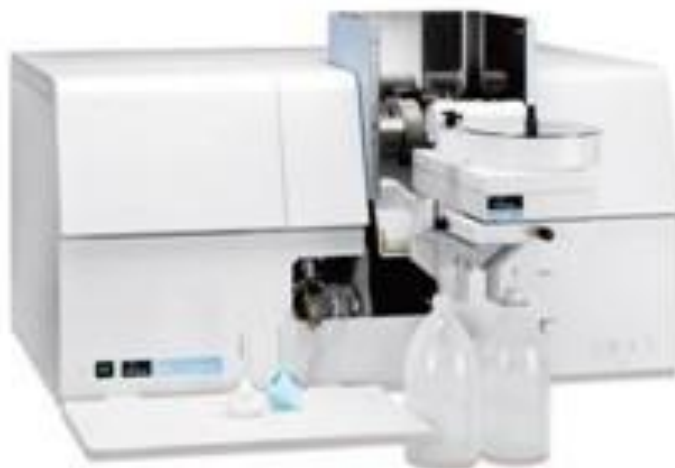
Εικόνα 29: Αναλυτής aanalyst 800 perkin elmer, με τον οποίο προσδιορίστηκαν τα βαρέα μέταλλα. [30]
