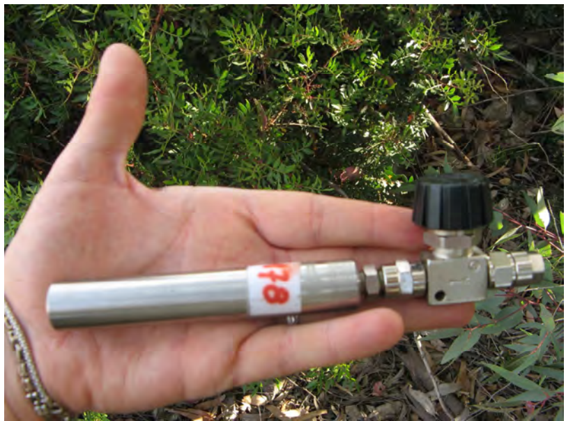
Fig. IV.12 Serbatoi per il contenimento dei campioni di geogas
