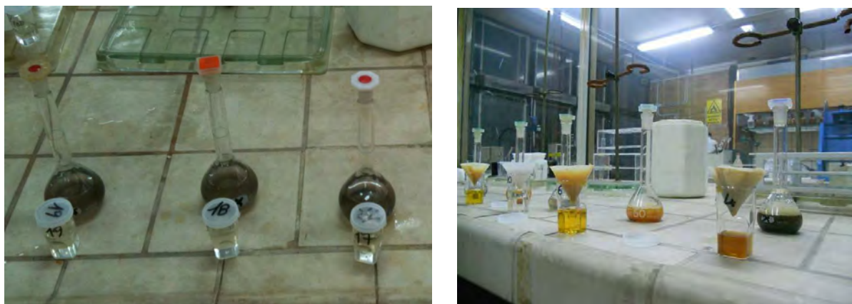
Fig. V.17 Particolare di alcune fasi della preparazione dei campioni per le analisi chimiche mediante ICP-OES
