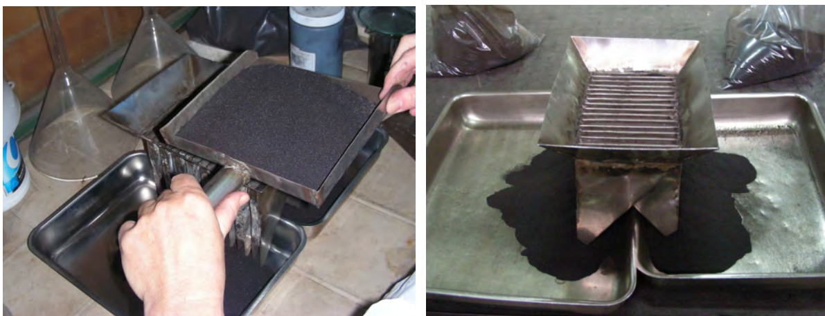
Fig. V.11 Particolare delle operazioni di quartatura del campione
