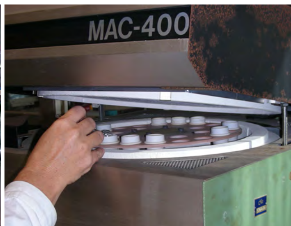
Fig. V.15 Sistemazione dei crogiuoli portacampioni all'interno del LECO MAC-400
