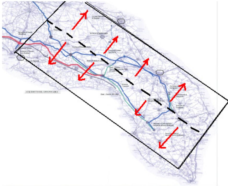
**Figura 8.2 – Schematizzazione dell'acquifero salentino in due semiacquiferi di lunghezza pari a 100 km e dimensione trasversale di 15 km – le frecce rosse indicano la direzione del flusso, che è congruente con la idrogeologia dell'acquifero reale**
