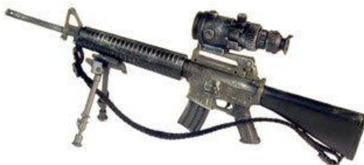
Obrázek 5 Nejznámější zástupce NVD druhé generace, puškohled AN / PVS-4 [14]
