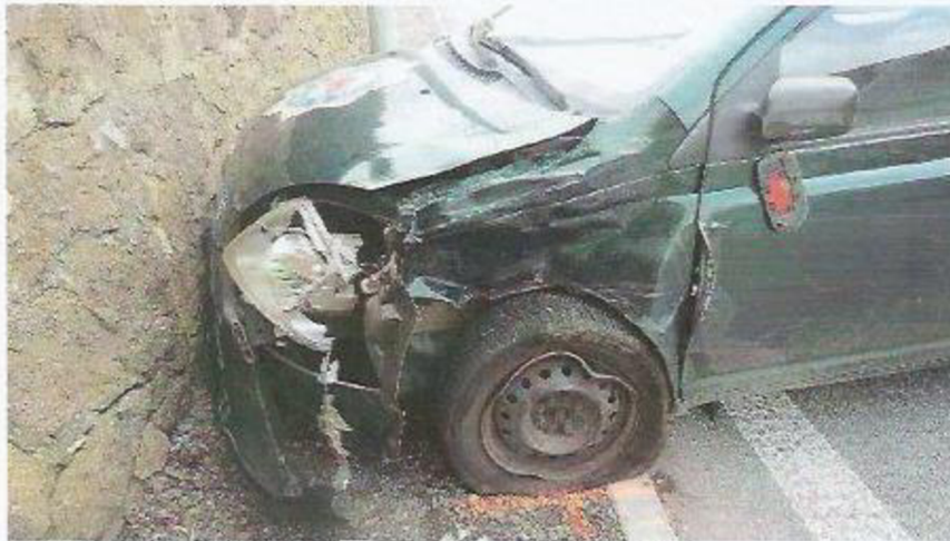
Snímek číslo 17: OA tov.zn. Toyota, RZ: - detail poškození levé přední části
