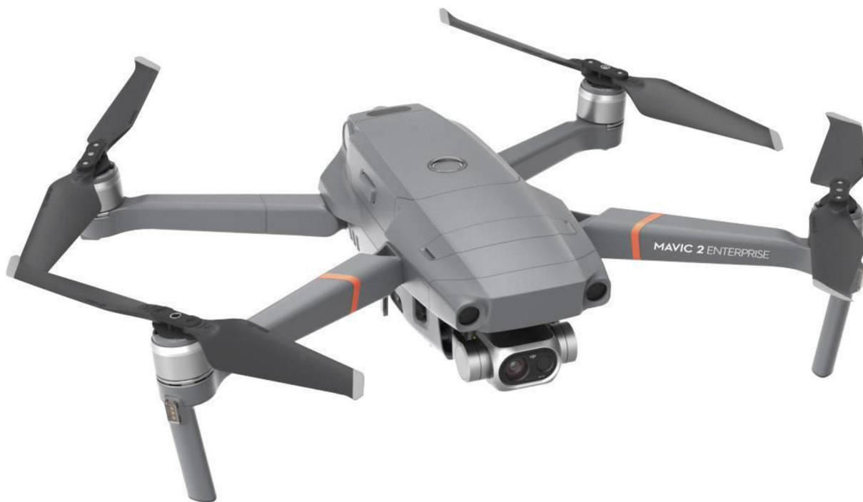
Obrázek č. 19: Dron DJI Mavic 2 Enterprise využívaný při dokumentaci dopravních nehod Zdroj: Dron Pro, online
