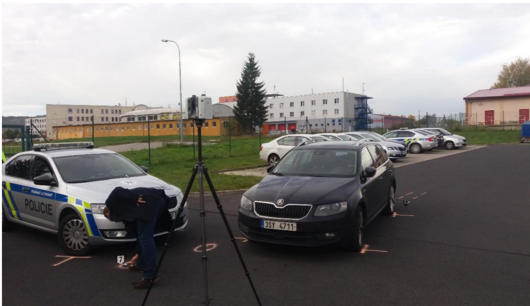
Obrázek č. 18: Zaměření dopravní nehody za pomoci 3D skeneru Zdroj: Interní zdroj Policie ČR – metodika k zaměření dopravních nehod
