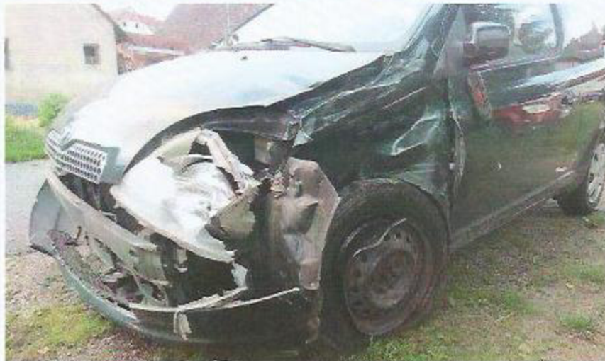
Snímek číslo 24: OA tov.zn. Toyota, RZ: - detail poškození levé přední části
