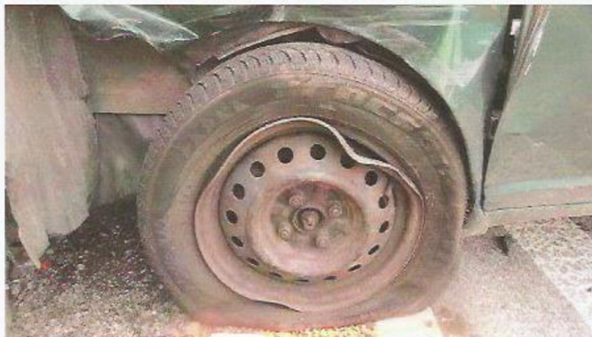
Snímek číslo 18: OA tov.zn. Toyota, RZ: - detail poškození levého předního kola
