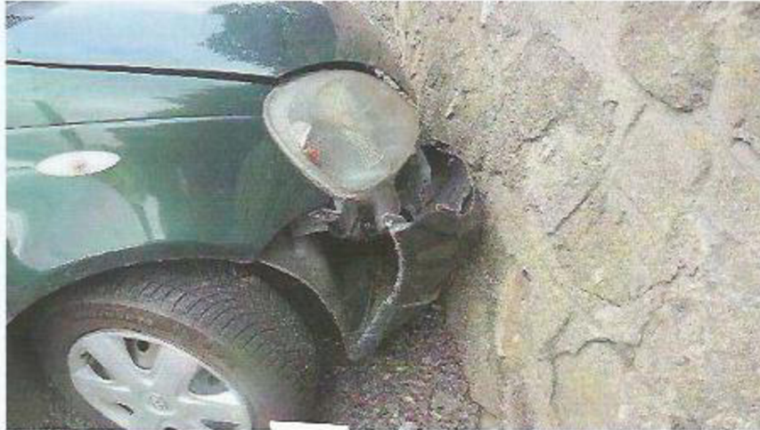
Snímek číslo 14: OA tov.zn. Toyota, RZ: střetu s kamenných tarasem detail poškození pravé přední části a detail místa
