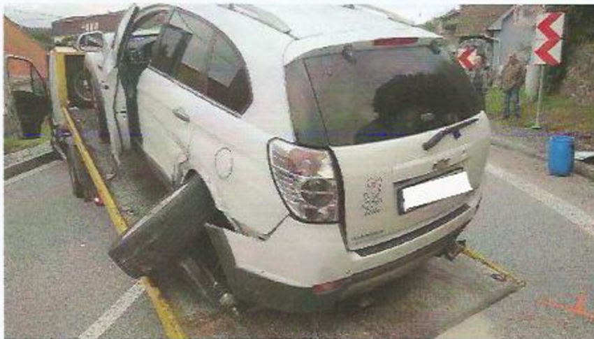
Snímek číslo 21: OA tov.zn. Chevrolet, RZ: - detail poškození zadní části a levého zadního kola
