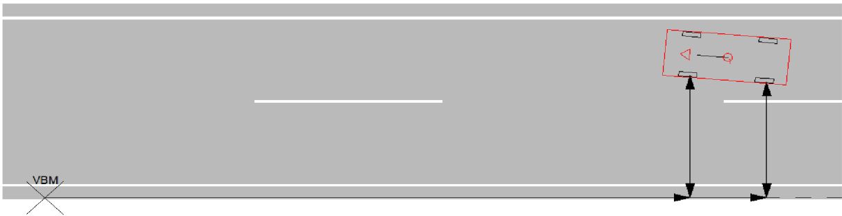
Obrázek č.5: Zaměření metodou pravoúhlých souřadnic Zdroj: Interní zdroj Policie ČR – metodika k zaměření dopravních nehod
