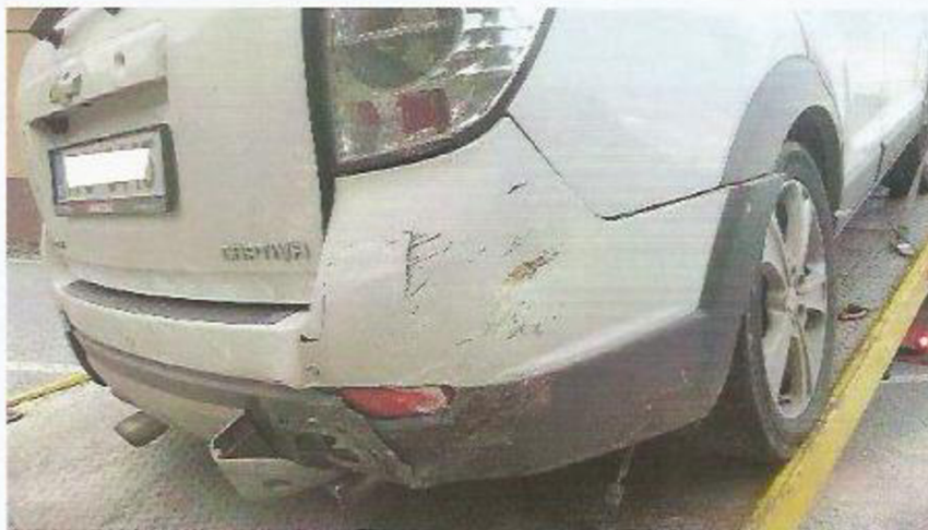
Snímek číslo 22: OA tov.zn. Chevrolet, RZ: - detail poškození zadního nárazníku
