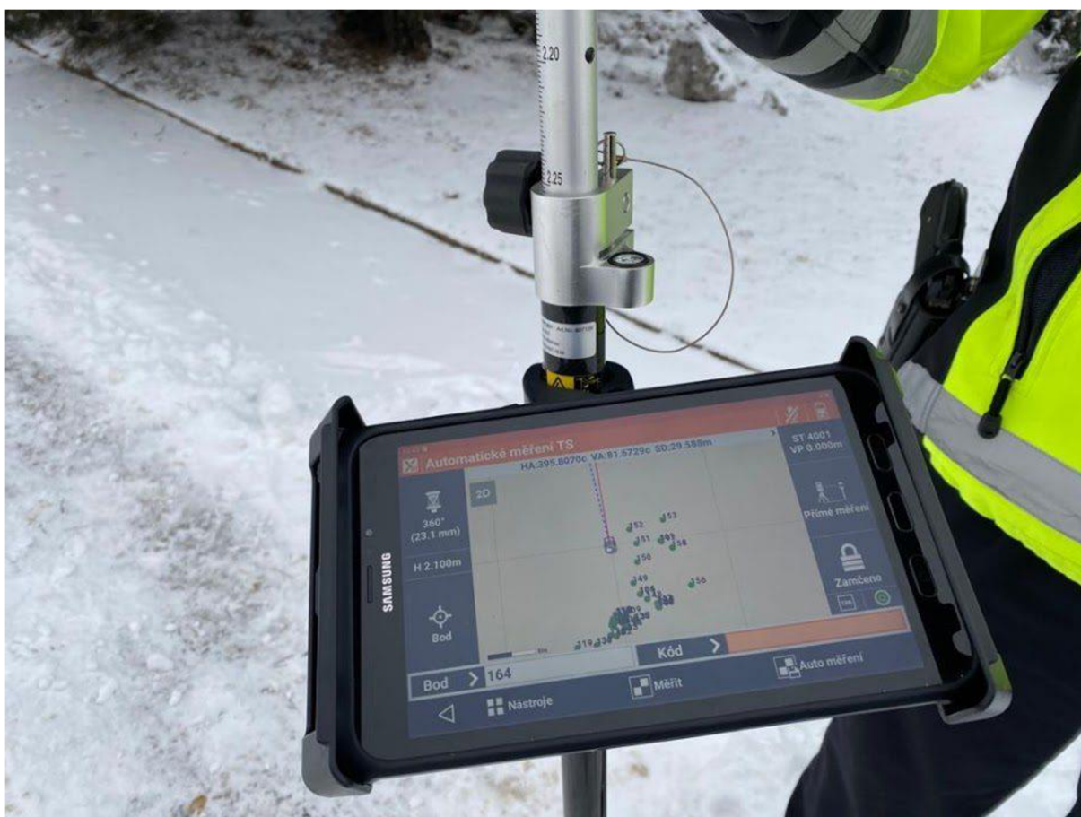
Obrázek 14: Detail ovládacího panelu u robotické totální stanice Zdroj: Český rozhlas, 2021, online
