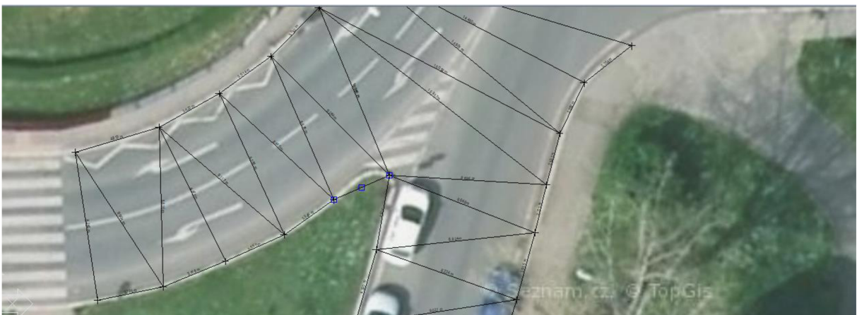
Obrázek č.6: Zaměření trojúhelníkovou metodou Zdroj: Interní zdroj Policie ČR – metodika k zaměření dopravních
