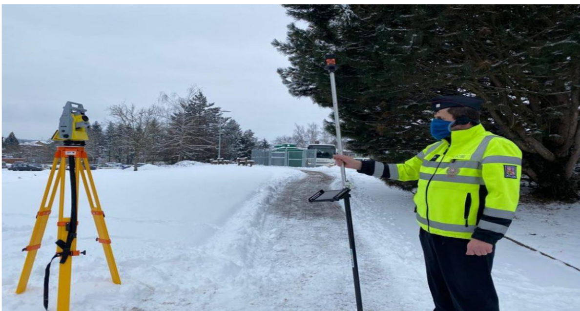
Obrázek 13: Ukázka zaměřování s robotickou totální stanicí Zdroj: Český rozhlas, 2021, online
