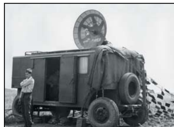
Střelecký radiolokátor SON-4 používaný u protiletadlové baterie 57 mm PLK
