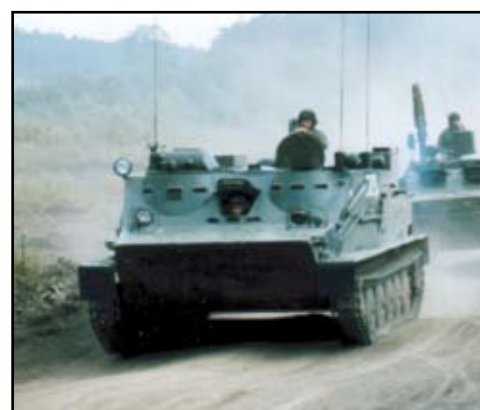
Verze obrněného transportéru OT-62/R-3 zajišťující spojení u pluků
