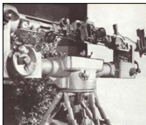
Kolektiv pracovníků dělostřeleckého vyzbrojení připravil pro ASTT v roce 1964 jako učební pomůcku řez dálkoměrem
