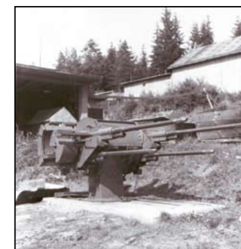
Prototyp 30mm PL čtyřkanónu SAMOTA na pivotové lafetě při zkušebních střelbách na strelnici v Hlbočém
