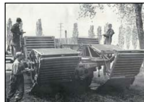
Automobil s vozovkovými deskami, součást střední mostové soupravy
