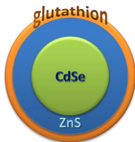
Obr. 19: Schematické znázornění kvantové tečky: CdSe jádro obalené ZnS a aktivované organickým ligandem pro zvýšení rozpustnosti ve vodě a zprostředkování vazebných interakcí (ligand je znázorněn jako kompaktní vrstva, v reálu tomu tak není)
