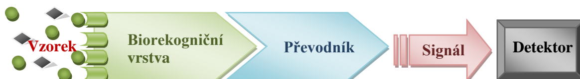
Obr. 1: Schematické znázornění biosensoru
