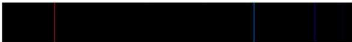
Obr. 7 čárové spektrum vodíku (převzato: http://cs.wikipedia.org/wiki/Čárové_spektrum )
