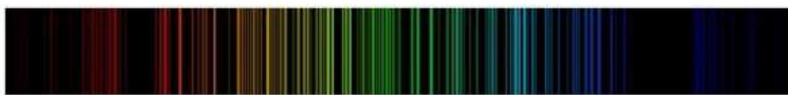
Obr. 8 čárové spektrum uhlíku (převzato: http://cs.wikipedia.org/wiki/Čárové_spektrum )
