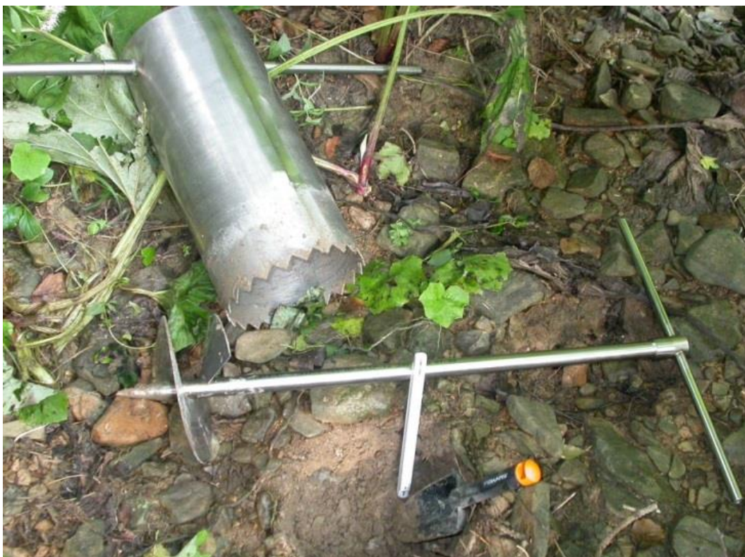
Obr. 7: Válnový vzorkovač použitý v den odběru
