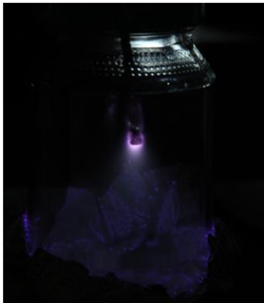
Obr. 20 Výboj ve spektrální sklenici – rtuť
