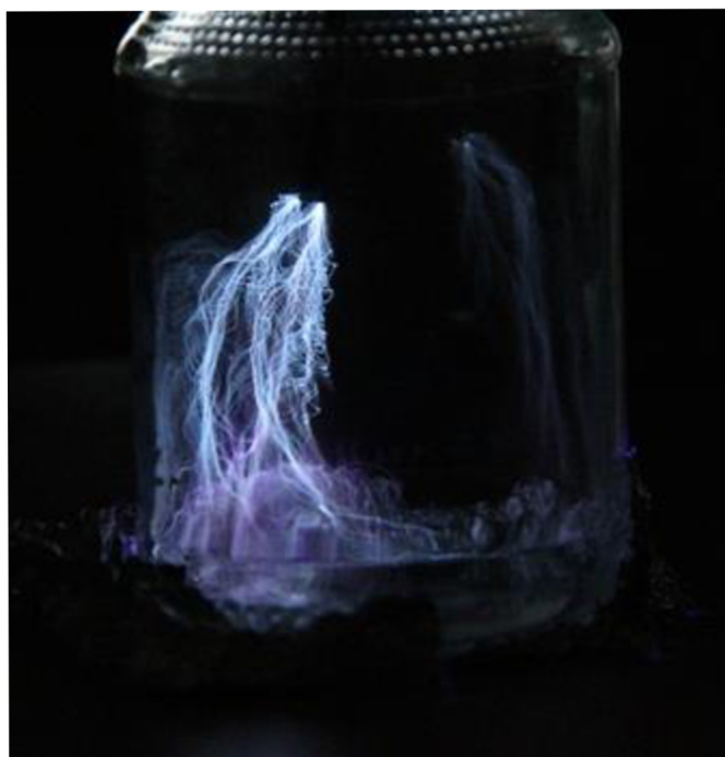
Obr. 22 Výboj ve spektrální sklenici – CO 2
