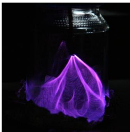
Obr. 21 Výboj ve spektrální sklenici– vzduch
