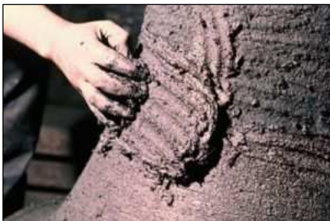
Obrázky: Postupné nanášení vrstev hlíny na jádro (vlevo nahoře), formování jádra vnitřní šablonou (vpravo nahoře)
