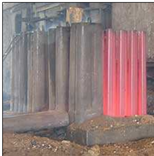
Obrázek: Kokily, vpravo kokily a ocelové ingoty
