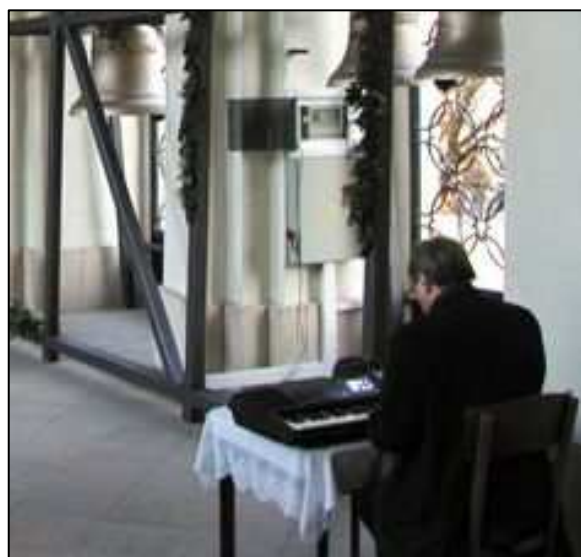
Obrázek: Systém táhel Lorety a elektrická klaviatura zvonohry ve Křtinách
