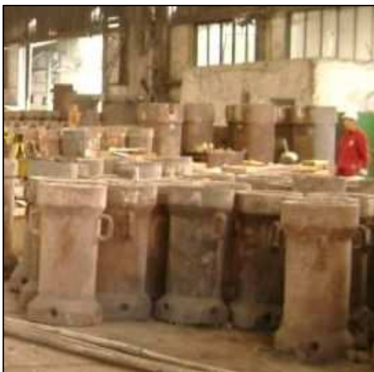
Obrázek: Kokily, vpravo kokily a ocelové ingoty
