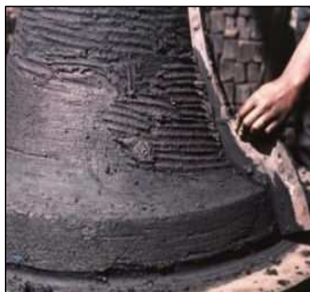
Obrázky: Postupné nanášení vrstev hlíny na jádro (vlevo nahoře), formování jádra vnitřní šablonou (vpravo nahoře)
