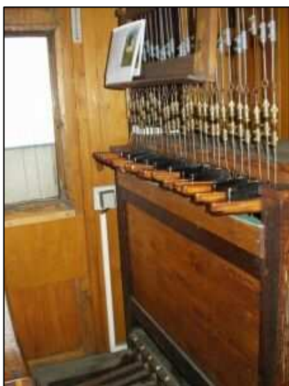
Obrázek: Systém táhel Lorety a elektrická klaviatura zvonohry ve Křtinách
