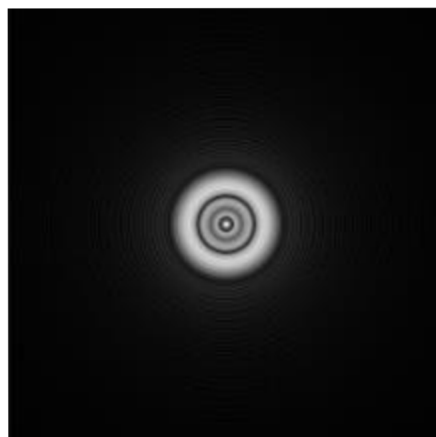
Obr. 38: Obraz bodového zdroje světla systémem zatíženým sférickou aberací
