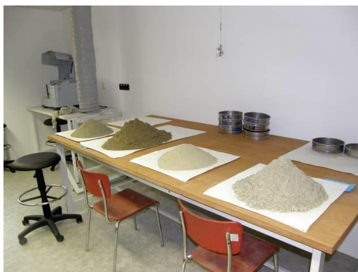
Obr. 18: Rozložení vzorků, sušení (foto: Mikysek)
