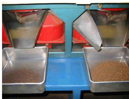
Obr. 22b: Elektromagnetická separace (www.diamondlab.com.au)
