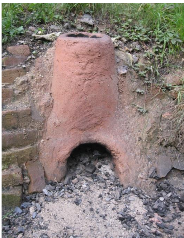
Obr. 3. Vestavěná pec s tenkou hrudí. ( foto autor )
