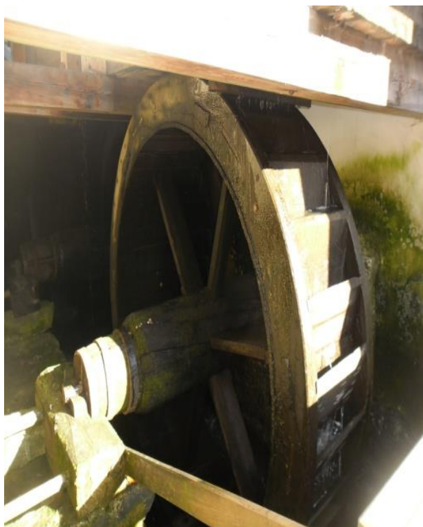
Obr. 39. Vodní kolo pohánějící hamr ( foto autor ).
