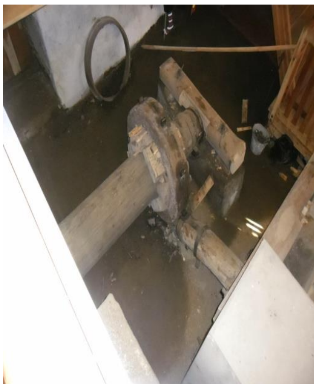
Obr. 40. Mechanismus uchycení vodního kola uvnitř hamru. ( foto autor ).
