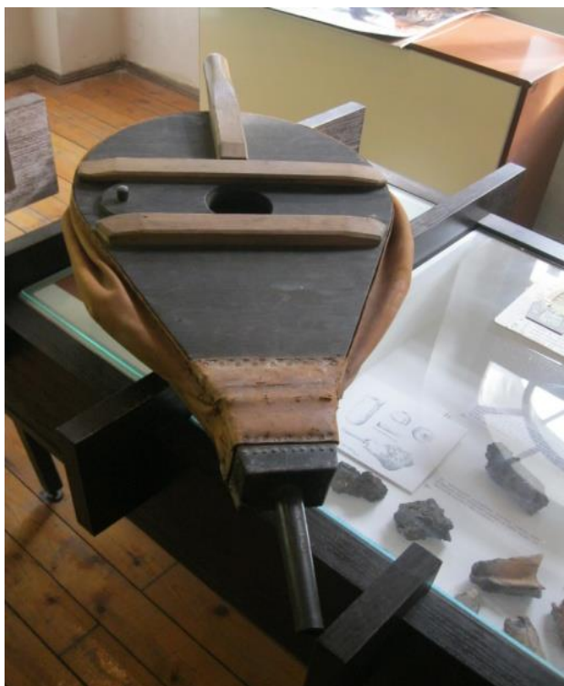
Obr. 27. Jednočinný měch na dmýchání do pece (foto autor).
