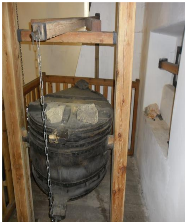
Obr. 42. Dvojčinný měch na dmýchání ( foto autor ).
