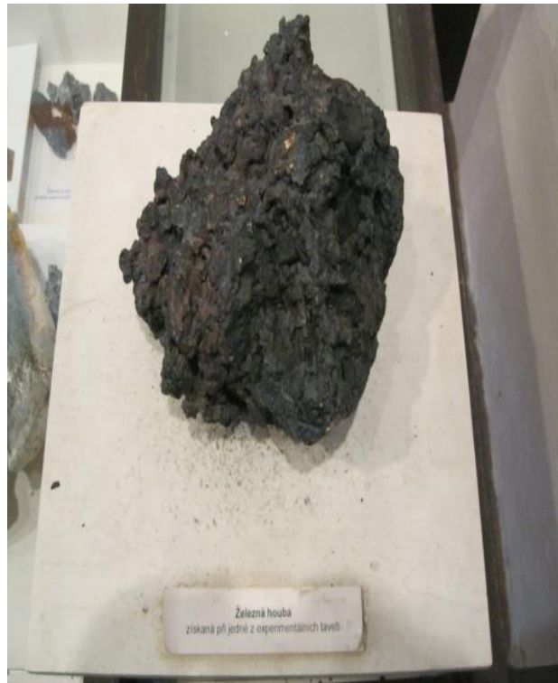
Obr. 29. Železná houba vzniklá při tavbě ( foto autor ).
