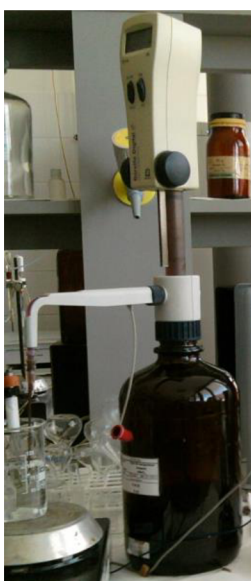
Obrázek 14: Digitální byreta Brand a zásobní láhev odměrného roztoku
