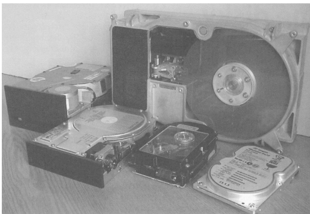
Obrázek 3.12: Srovnání velikostí pevných disků (zleva doprava): 10 MB (1983), 20 MB (1986), 40 MB (1990) a 20 GB (1999). Vzadu je 160MB disk (1986). [14]
