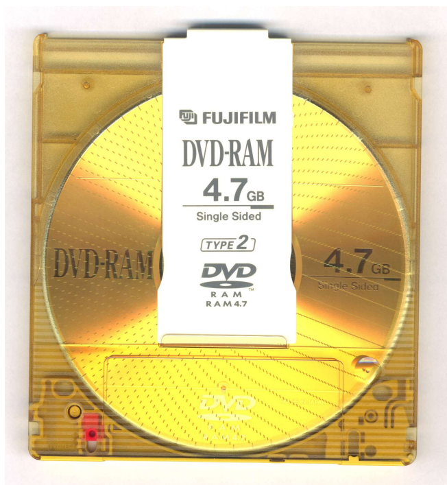
Obrázek 4.4: DVD-RAM v prachotěsné kazetě s (bílým) posuvným krytem [48]
