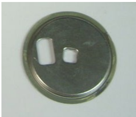
Obrázek 3.8: Kovový střed 3,5" diskety s indexovým otvorem a středovým přichycovacím otvorem
