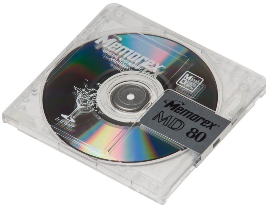
Obrázek 3.24: Magnetooptický disk typu MiniDisc (MD) určený k uložení hudby [41]
