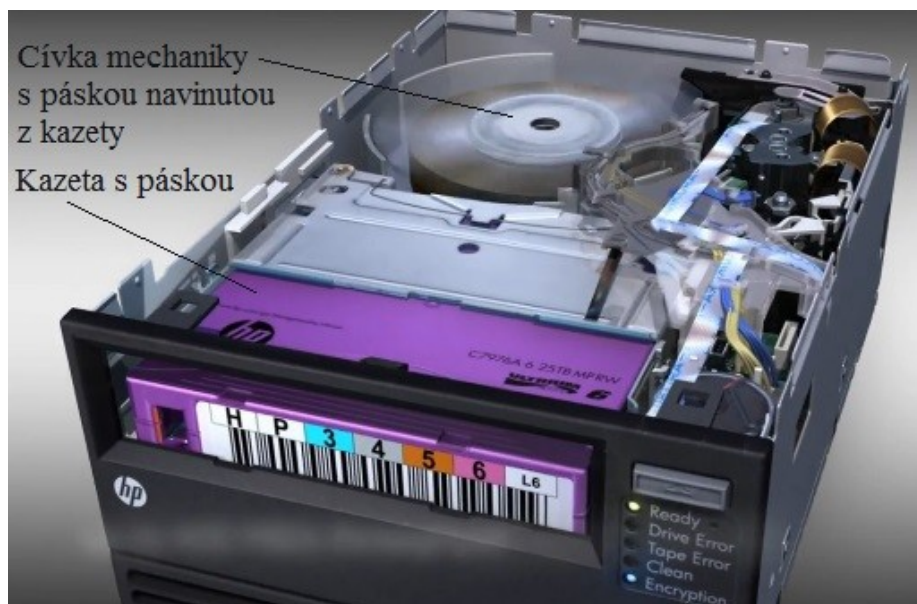
Obrázek 3.22: Navíjení magnetické pásky z kazety na cívku páskové mechaniky [39]
