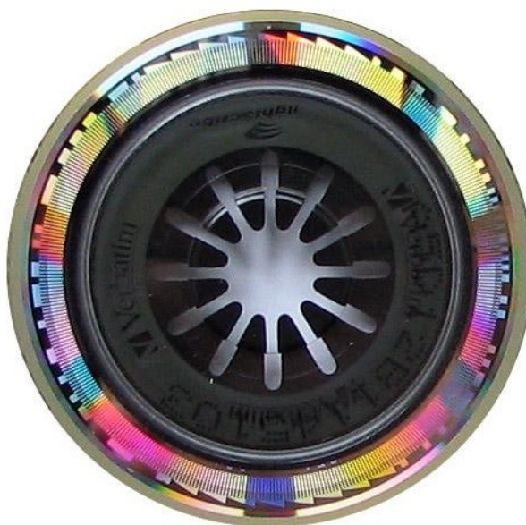
Obrázek 4.10: Vnitřní kotouček optického disku s podporou technologie LightScribe [49]
